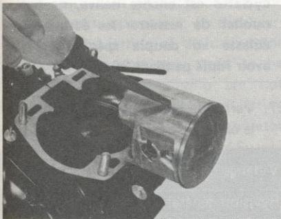
Vérifier le serrage de tous les boulons de fixation du moteur.
